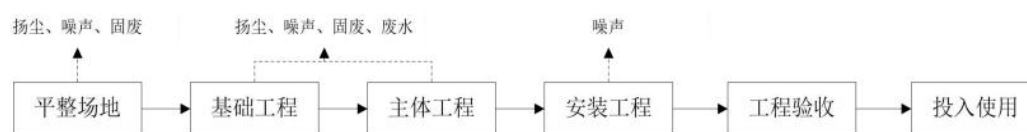
图 2-2 本项目施工工序及排污节点示意图
